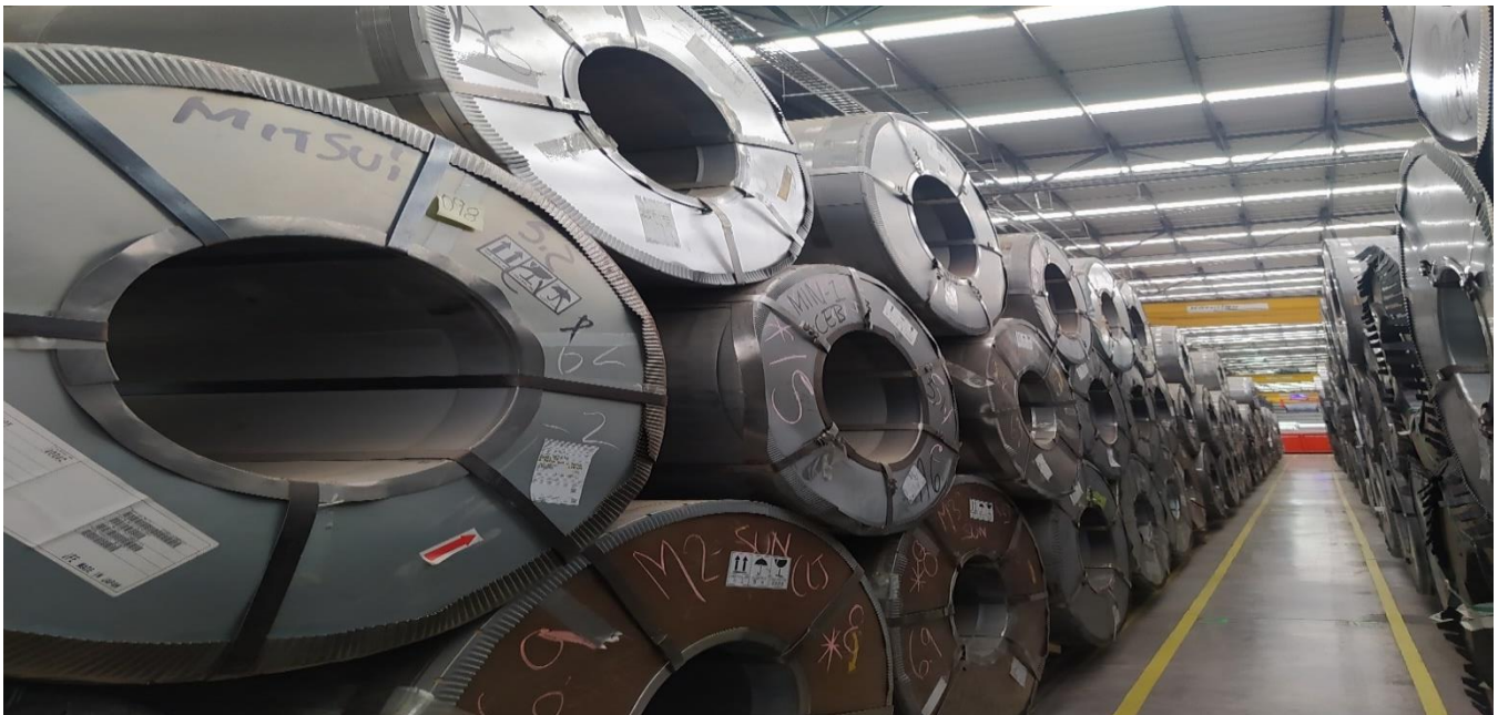
Imagen 21. Rollos en tercera estiba y fuera de regla.
